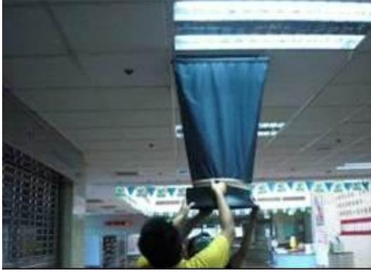
出風口風量測量與調整，使各風口風量平衡，以達到室內人員舒適及節能之目的
