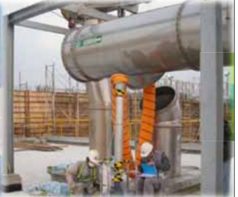
風管洩漏測試
