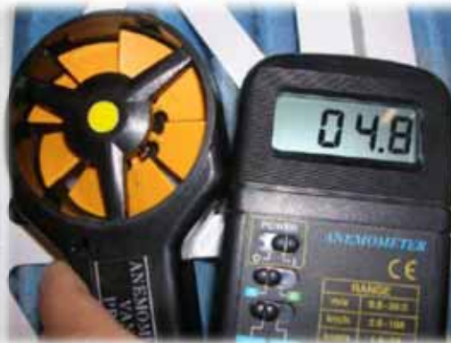
空調設備風量平衡及測試
