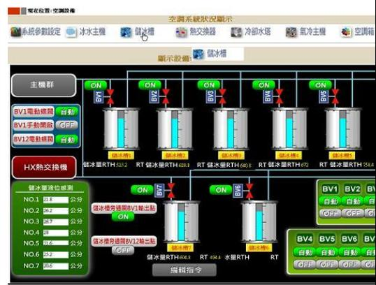
BEMS 之空調主機加卸載功能，有效管理空調主機群台數運轉，防止尖峰用電超約罰款。
